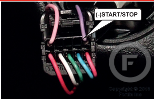
③ Push-to-start button Bouton démarrage
