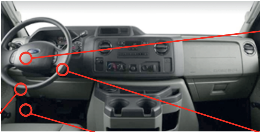
③ Gateway module, Behind OBD-II connector Module Passerelle réseau, Derrière le connecteur OBD-II
