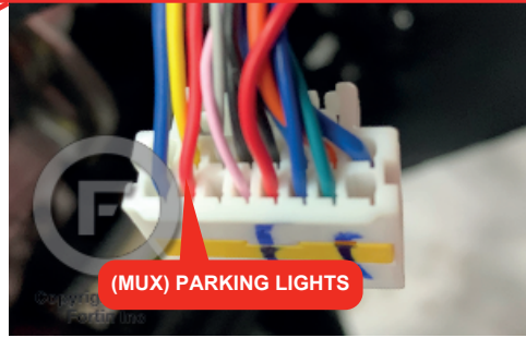
③ At headlight-Wiper switch Au commutateur de phare-Essui glace
