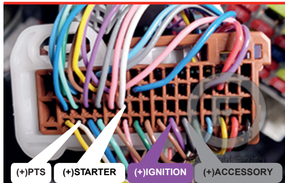
① BCM Brown 66-PINS connector. BCM Connecteur Brun de 66-PINS.
