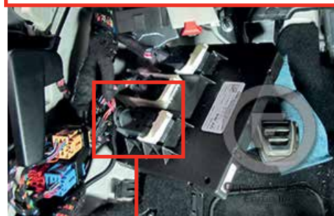
③ VESCM - Electrical System Control Module under dash driver side, above Driver Kick Panel VESCM - Module de contrôle de système électrique sous le tableau de bord côté conducteur, au-dessus du panneau latérale.
