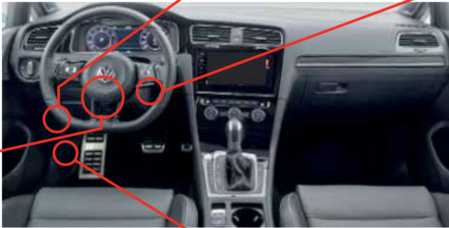
③ VESCM - Electrical System Control Module under dash driver side, above Driver Kick Panel VESCM - Module de contrôle de système électrique sous le tableau de bord côté conducteur, au-dessus du panneau latérale.
