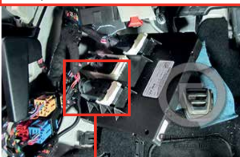
③ VESCM - Electrical System Control Module under dash driver side, above Driver Kick Panel VESCM - Module de contrôle de système électrique sous le tableau de bord côté conducteur, au-dessus du panneau latérale.
