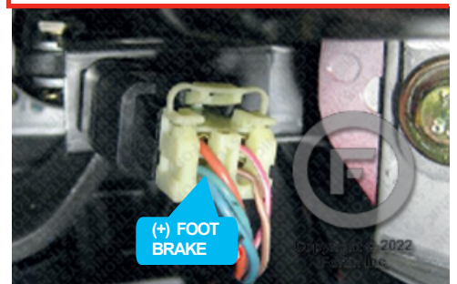
④ At brake switch Au commutateur de frein
