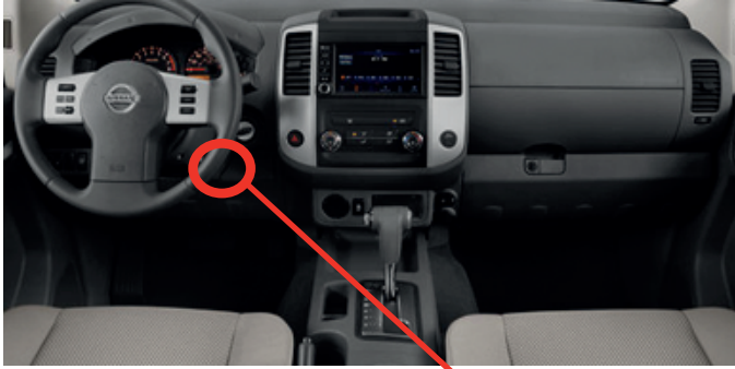
③ BCM Grey 24-Pin connector BCM Connecteur Gris de 24-pins
