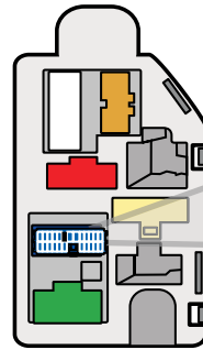
① Passenger-side kick panel, Blue connector (back view). Panneau latéral côté passager Connecteur Bleu (Vue de dos)
