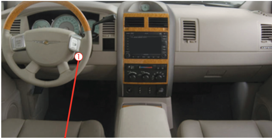
① At transponder connector Au Connecteur du transpondeur
