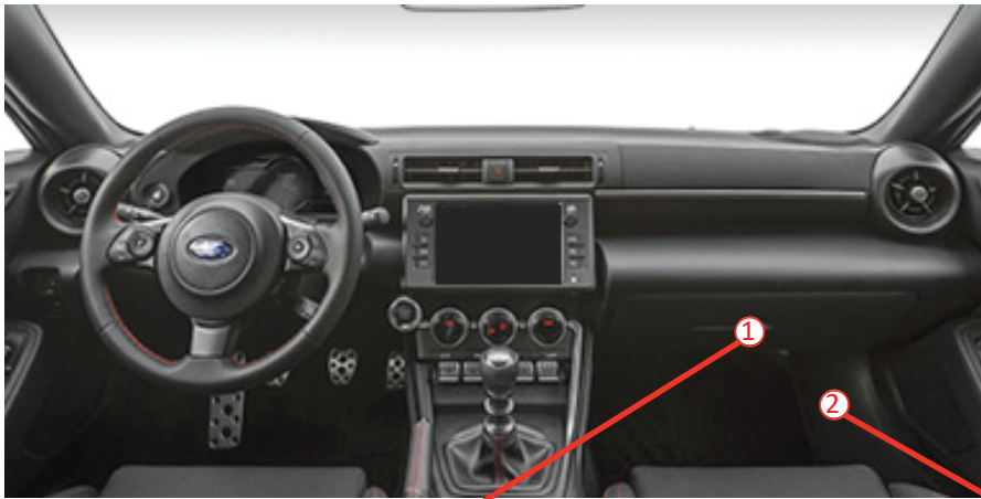
① Smart key module, behind glovebox. Module d'accès sans clé, derrière le coffre à
