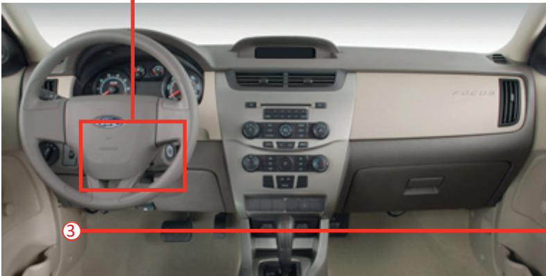
③ Smart Junction Box, Connecteur A Boîte de Jonction est situé dans le Panneau Latéral Conducteur
