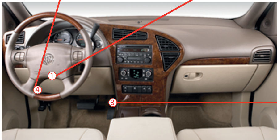
③ At BCM, at fuse box in center control Au BCM, à la boîte à fusibles de la console centrale
