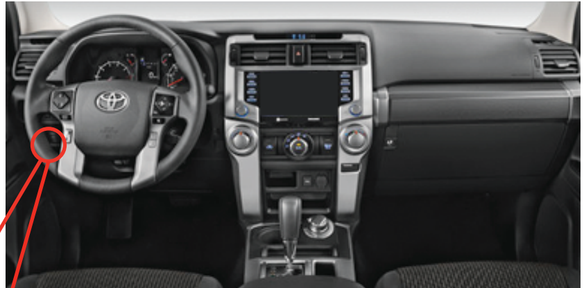
② MAIN BODY ECU - BELOW DASH FUSE BOX MAIN BODY ECU - SOUS LE TABLEAU DE BORD, SOUS LA BOÎTE À FUSIBLES
