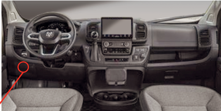
② Fuse box Boîte à fusibles
