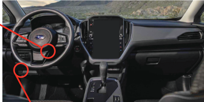
② Back of fuse box Au dos de la boîte à fusibles
