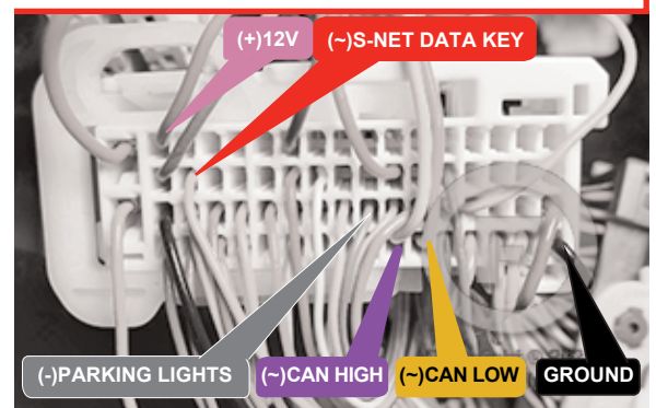
② BCM White 66-PINS connector. BCM Connecteur Blanc de 66-PINS.
