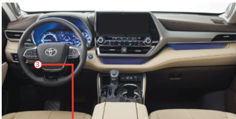
③ Hybrid ECU, beside fuse box in dash bord. ECU Hybride, à côté de la boîte à fusibles dans le tableau de bord.
