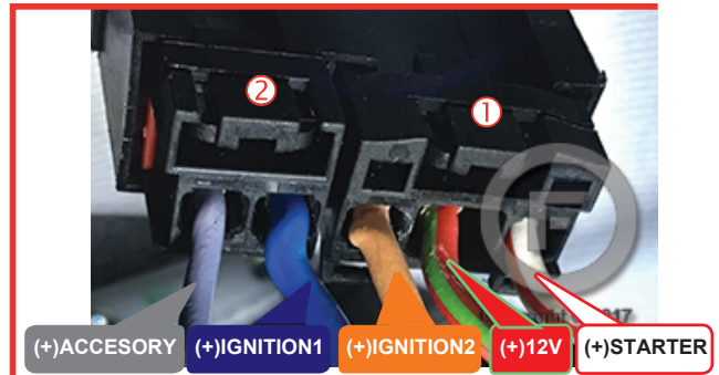
① ② Ignition switch. Commutateur d'ignition.
