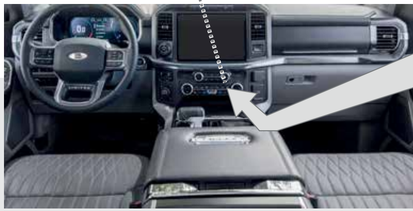
Gateway module, behind audio panel in center dash - 26-pin Black connector. Au module Gateway, derrière le panneau de l'audio dans la console centrale - Connector Noir de 26-pin.
