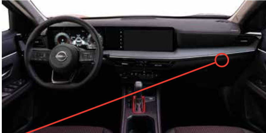
① Intelligent key system, below passenger side airbag Au système de clé intelligente, sous le coussin gonflable côté passager
