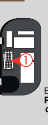
① Back view White 31-pin connector Driver Kick Panel. Vue de dos Connecteur Blanc de 31 pins Panneau latéral côté chauffeur.
