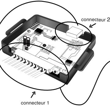
**Note:** Le connecteur 2 est utilisé seulement pour les véhicules Cadillac ou lorsque la lumière SÉCURITÉ s'allume après démarrage. (voir diagrammes ci-dessous).
