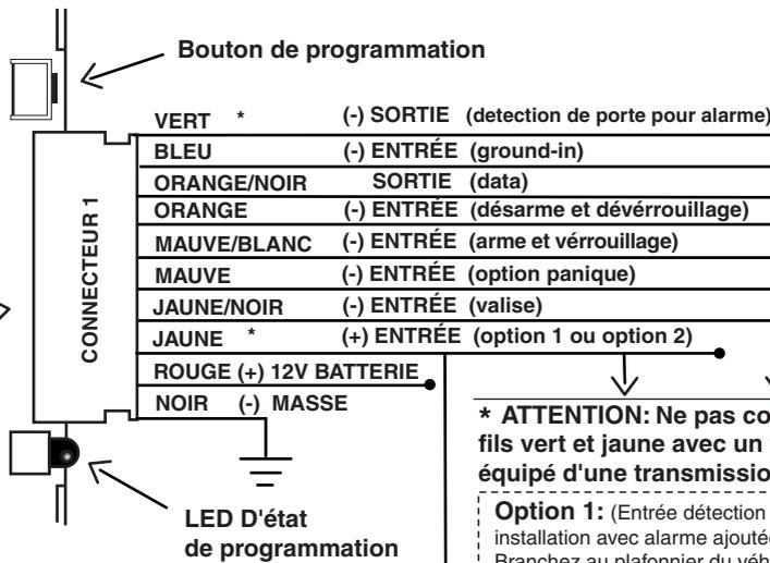
**\* ATTENTION: Ne pas connecter les fils vert et jaune avec un véhicule équipé d'une transmission manuelle**
