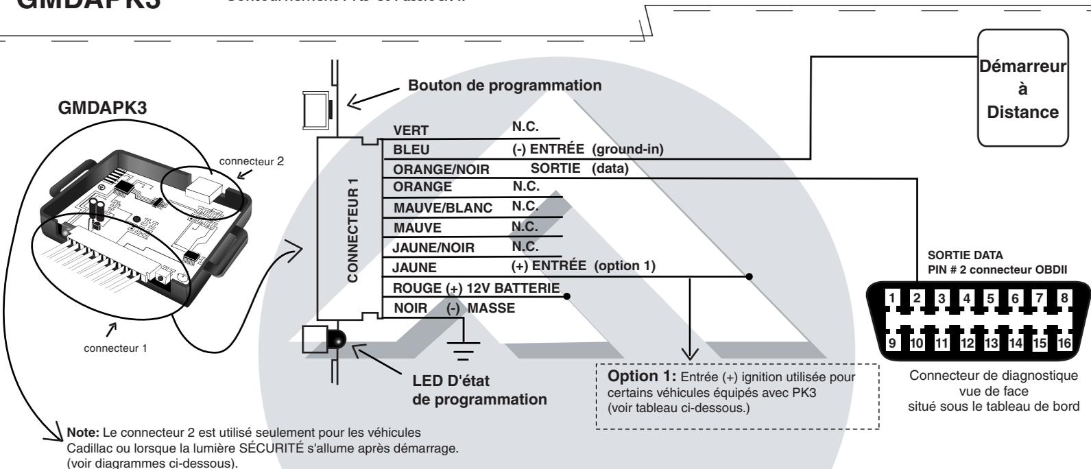
**Note:** Le connecteur 2 est utilisé seulement pour les véhicules Cadillac ou lorsque la lumière SÉCURITÉ s'allume après démarrage. (voir diagrammes ci-dessous).
