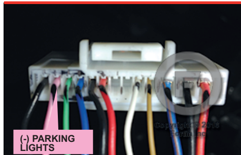
③ At Parking Light switch connector Au connecteur du commutateur des lumières de stationnement
