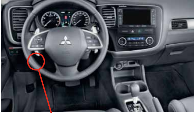
① Fuse box Boîte à fusibles
