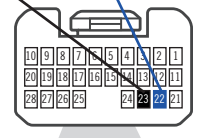
② B Back view White 28-pin connector Main body ECU. Vue de dos Connecteur Blanc de 28 pins Main body ECU.
