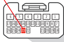
② A Back view White 26-pin connector Main body ECU. Vue de dos Connecteur Blanc de 26 pins Main body ECU.
