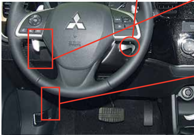
② ⑤ ⑥ Harness in Driver kick panel, close to fire wall Harnais dans le panneau latéral côté conducteur, prêt du pare-feu
