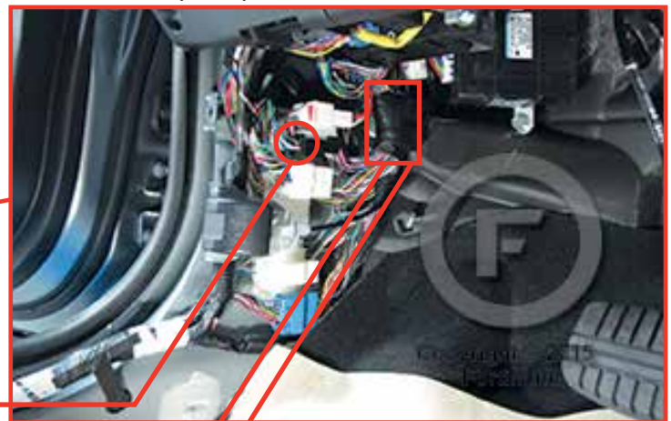
② ⑤ ⑥ Harness in Driver kick panel, close to fire wall Harnais dans le panneau latéral côté conducteur, prêt du pare-feu
