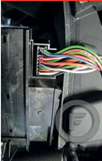
① Key port connector Connecteur du récepteur de la clé
