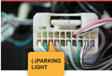
⑦ Parking Light Switch Commutateur des feux de stationnement.
