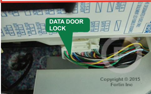
① Under fuse box Sous la boîte à fusibles
