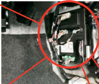
BCM located in passenger kick panel | BCM Situé dans le panneau latéral côté passager
