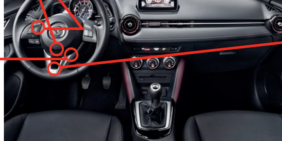
② Under steering column, START-STOP unit Sous la colonne de direction, unité DEMARRAGE
