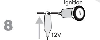
À l'aide d'un fil (Jumper), vous devez **alimenter le 12V ignition** du véhicule jusqu'à ce que le témoin arrête de clignoter et reste allumé.
