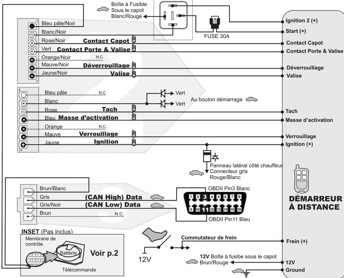
Branchement du filage au d marreur   distance / Alarme Branchement du filage au v hicule ○ SORTIE ● ENTR E
