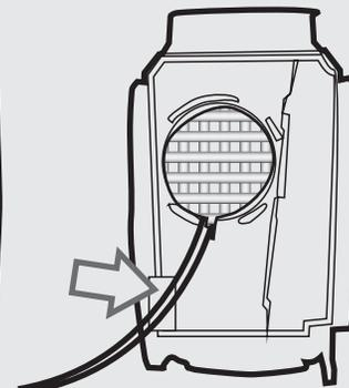
Coupez un petit coin à l'intérieur de la télécommande pour passer les fils et ré-assemblez la télécommande.
