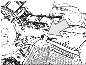
Ignition (+): Vert/Violet Fil blanc du CAN-SL2 (-): Jaune/Orange (Mesurez ce fil avec un multimètre. Il devrait baisser de 5VDC à 3VDC quand le bouton marche est pressé)
