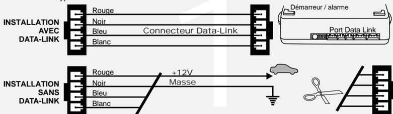
Coupez les 4 fils à l'extrémité de l'un des deux connecteurs Data-Link.
