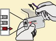
If the LED is solid RED disconnect the 4 Pin connector (Data-Link) and go back to step 1. Si le DEL est ROUGE solide débranchez le connecteur 4 pins (Data-Link) et retournez à l'étape 1.
