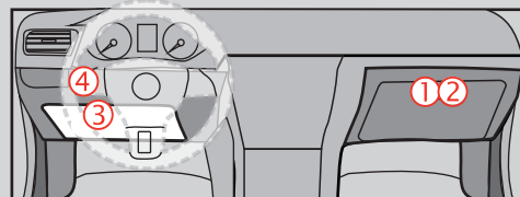
④ Back view - Blue connector at Parking lights switch Vue de dos - Connecteur Bleu au commutateur des feux de stationnement
