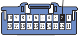
③ Back view - Blue connector under steering column Vue de dos - Connecteur Bleu sous la colonne de direction
