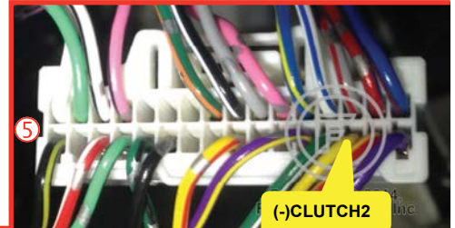
⑤ Under steering column, START-STOP unit. Sous la colonne de direction, unité DÉMARRAGE.
