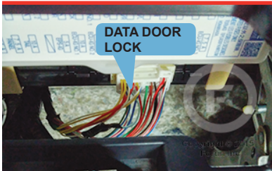
⑥ Under fuse box Sous la boîte à fusibles
