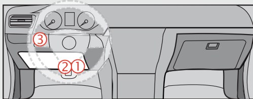
① Back View 36-pins Grey connector Vue de dos Connecteur Gris de 36-pins
