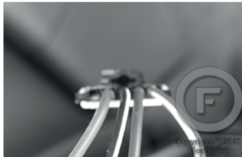
② Transponder connector Connecteur du transpondeur
