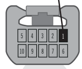
① Back view 10-Pin Black Connector Push-to-start button Vue de dos Connecteur Noir de 10 Pins Bouton démarrage
