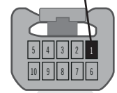
① Back view 10-Pin Black Connector Push-to-start button Vue de dos Connecteur Noir de 10 Pins Bouton démarrage
