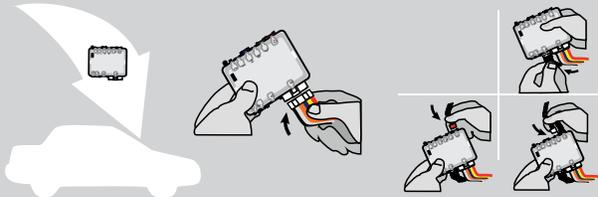
**APRÈS LA PROCÉDURE DE PROGRAMMATION DCRYPTOR COMPLÉTÉE** : retournez au véhicule et rebranchez le connecteur 6-pins (Connecteur principal) et après tous les connecteurs.
