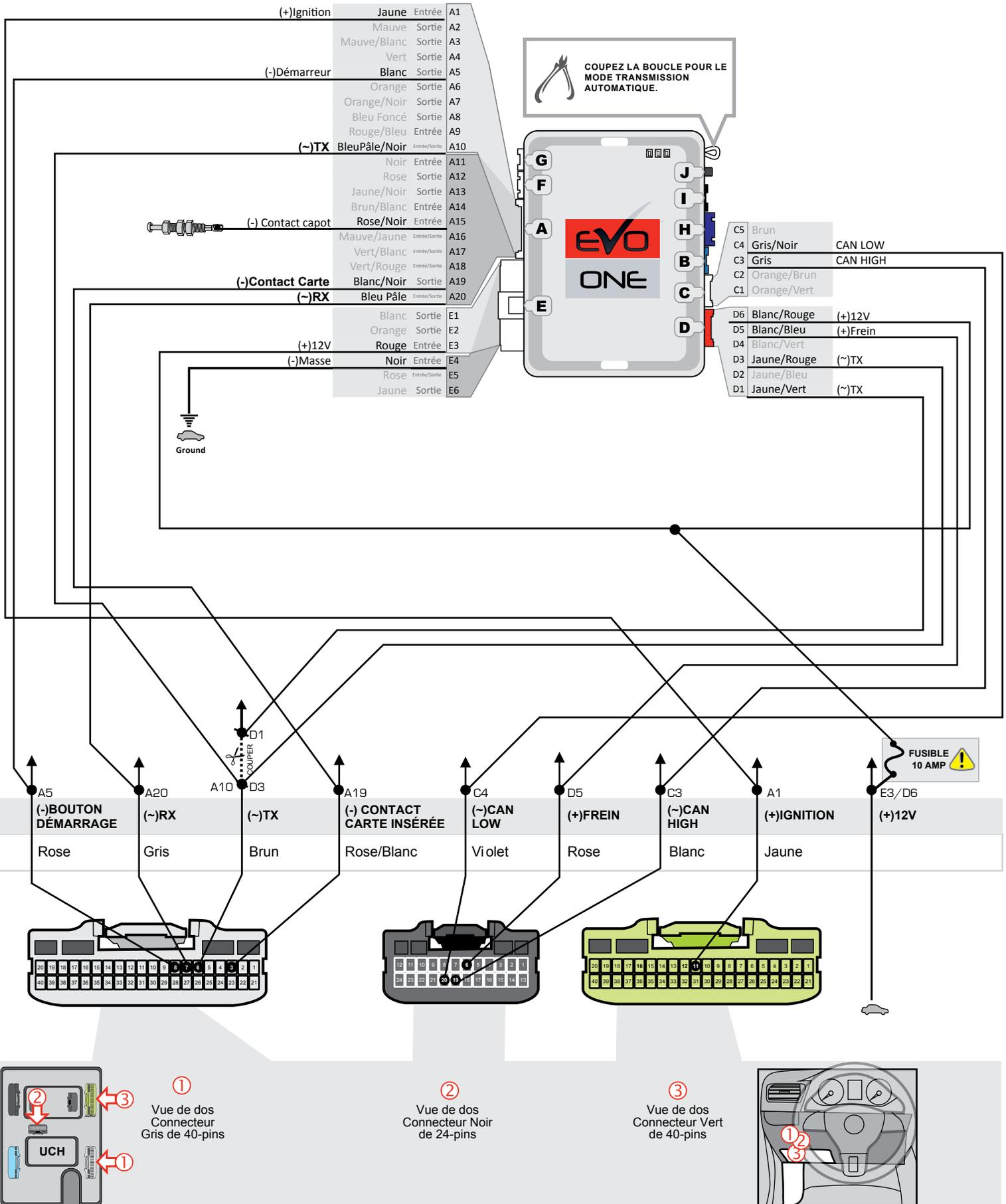
Au UCH, sous le tableau de bord, côté conducteur
