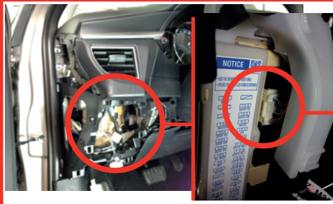
① BCM, connector located beside the fuse cover BCM, connecteur à côté du couvercle à fusibles
