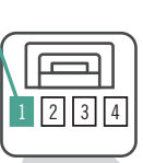
④ 4-Pin Back View White connector At clutch switch. Connecteur Blanc Vue de dos de 4-pins Au commutateur de la pédale d'embrayage.
