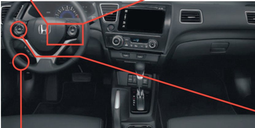
④ Below Fusebox, Small green connector to the left. Sous la boîte à fusibles, petit connecteur vert à gauche.
